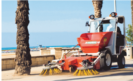
Balayeuse mécanique dédiée basée sur un modèle de dumper B120RM
